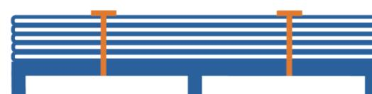
Ausreichende Transportsicherung ist unumgänglich. Es ist darauf zu achten, dass Kanten durch geeignetes Polstermaterial geschützt sind. Zylindrische Teile sind ggf. durch verschraubte Kanten zu stützen.
