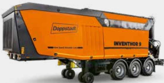
»Unsere Inventhor Baureihe vereint das Beste aus der seit Jahrzehnten bewährten Verfahrenstechnik des beliebten Vorgängers »Büffel« DW 3060 mit dem intelligenten Antriebskonzept VarioDirect Drive. Das separate Einstellen von Walzen- und Motordrehzahl erhöht Effizienz und Einsatzmöglichkeiten, indem Sie als Anwender die Maschine flexibel an Ihre Bedürfnisse anpassen können.«
