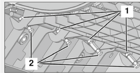
Abb. 9: Sechskantschrauben an der oberen Heckkorbwechselgitteraufnahme
